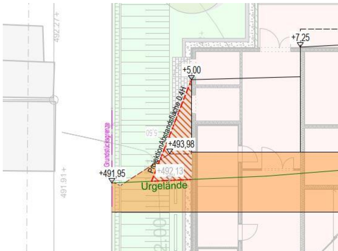
Abbildung 2: Darstellung der gesetzlichen Abstandsfläche
