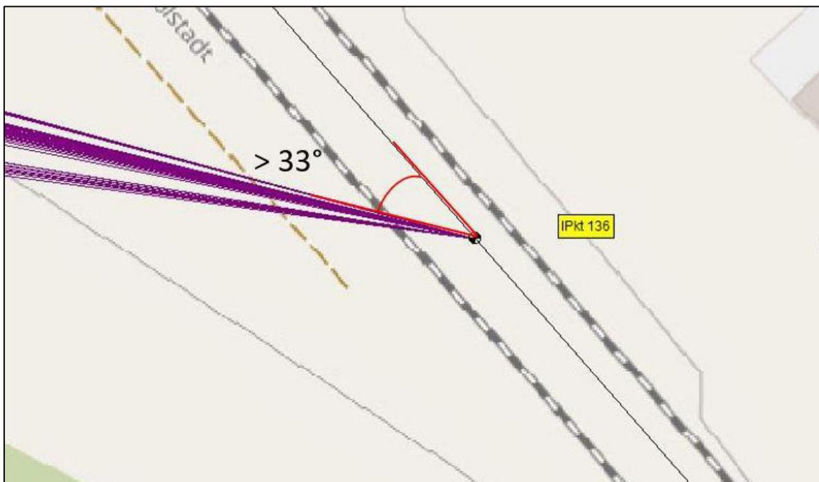
**Abbildung 3: Darstellung der Reflexionsstrahlen auf IPkt 136**
